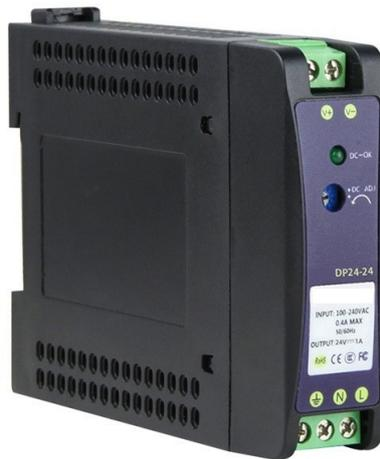
SUN-DP24-24 è un alimentatore da 24W per guida DIN conforme agli standard industriali tedeschi. È adatto per l'installazione su guide TS-35/7,5 o TS-35/15, utilizza un ingresso da 90VAC a 264VAC ed è conforme alla norma EN61000-3-2 sulle specifiche di corrente armonica specificate dall'Unione Europea.
