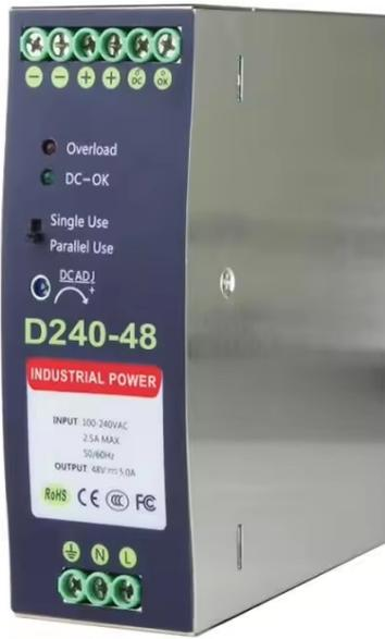
SUN-DP240-48 è un alimentatore per guida DIN da 240 W conforme agli standard industriali tedeschi. È adatto per l'installazione su guide TS-35/7,5 o TS-35/15, utilizza un ingresso da 90VAC a 264VAC ed è conforme alla norma EN61000-3-2 sulle specifiche di corrente armonica specificate dall'Unione Europea.
