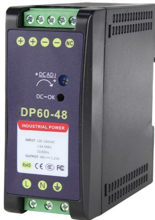
SUN-DP60-48 è un alimentatore da 60 W per guida DIN conforme agli standard industriali tedeschi. È adatto per l'installazione su guide TS-35/7,5 o TS-35/15, utilizza un ingresso da 90VAC a 264VAC ed è conforme alla norma EN61000-3-2 sulle specifiche di corrente armonica specificate dall'Unione Europea.
