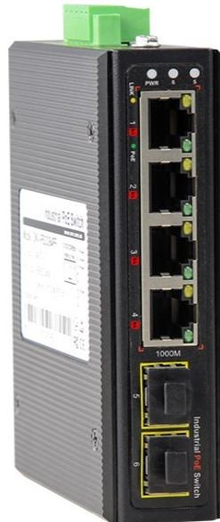
SUN-IPS33064PF-bt è uno switch industriale bt PoE in fibra full gigabit non gestito. Dispone di 4 porte RJ45 adattive 10/100/1000M e 2 porte SFP uplink 1000M in fibra. Le porte 1-4 supportano lo standard PoE IEEE 802.3 af/at/bt e la potenza di uscita PoE a porta singola è di 90W. Fornisce un'alimentazione stabile e sicura per le telecamere di rete, le telecamere PTZ, gli AP wireless ad alta potenza.
