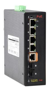
SUN-IPS33064PFM è uno switch industriale PoE gestito full Gigabit L2+. Dispone di 4\* porte RJ45 adattive 10/100/1000M e 2\* porte SFP 100/1000M. Le porte 1-4 supportano lo standard IEEE802.3af/at PoE. Alimentazione POE a porta singola fino a 30W. Come dispositivo di alimentazione PoE, è in grado di rilevare e riconoscere automaticamente i dispositivi conformi allo standard e di fornire alimentazione attraverso il cavo di rete.
