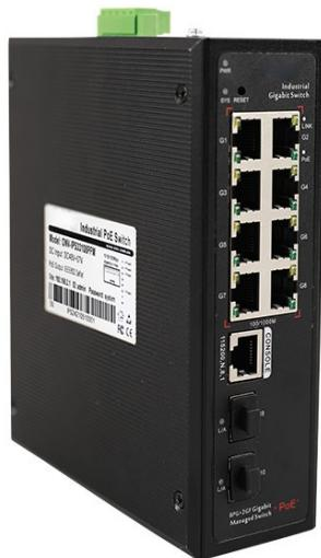
SUN-IPS33108PFM-bt è uno switch in fibra PoE industriale gestito Gigabit L2+. Dispone di 8\* porte RJ45 adattive 10/100/1000Base-T e 2\* porte SFP 100/1000Base-X in fibra. La porta 1-8 supporta lo standard IEEE 802.3 af/at/bt PoE e la potenza PoE a porta singola fino a 90W. Come dispositivo di alimentazione PoE, è in grado di rilevare e identificare automaticamente i dispositivi alimentati conformi agli standard e di alimentarli attraverso i cavi di rete.
