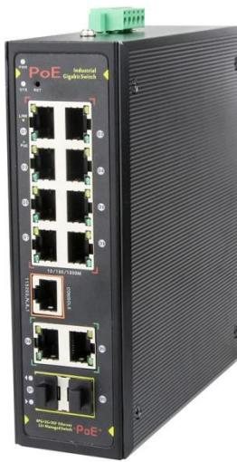
SUN-IPS33128PFM è uno switch PoE industriale gestito full Gigabit. Dispone di 10 porte RJ45 10/100/1000M e 2 porte SFP 100/1000M con slot in fibra, la porta 1-8 può supportare l'alimentazione POE standard IEEE 802.3af/at, la potenza POE della singola porta fino a 30W e la potenza massima di uscita POE è 120W (at-240W). Come dispositivo di alimentazione POE, è in grado di rilevare e identificare automaticamente le apparecchiature e di fornire alimentazione attraverso il cavo.
