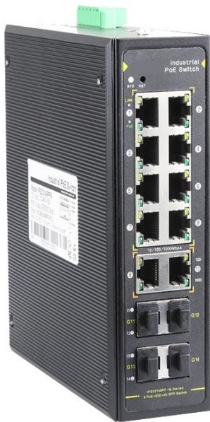
SUN-IPS33148PFM è uno switch industriale gestito in fibra PoE full Gigabit L2+. Supporta 10\*10/100/1000Base-T porte RJ45 adattive e 4\*100/1000Base-X porte SFP. Le porte 1-8 supportano lo standard IEEE 802.3 af/at PoE e la potenza PoE della singola porta raggiunge i 30W. Come dispositivo di alimentazione PoE, è in grado di rilevare e identificare automaticamente i dispositivi alimentati conformi agli standard e di alimentarli attraverso i cavi di rete.
