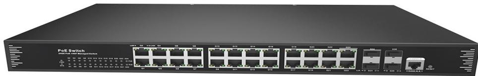
SUN-POE33026PFM è uno switch in fibra PoE gestito gigabit L2+. Dispone di 24\* porte RJ45 10/100/1000Base-T e 2\* porte SFP 100/1000Base-X in fibra. Le porte 1-24 supportano lo standard IEEE802.3af/at PoE. La potenza della singola porta PoE raggiunge i 30W. Come dispositivo di alimentazione PoE, è in grado di rilevare e riconoscere automaticamente le apparecchiature e di fornire l'alimentazione attraverso il cavo di rete.
